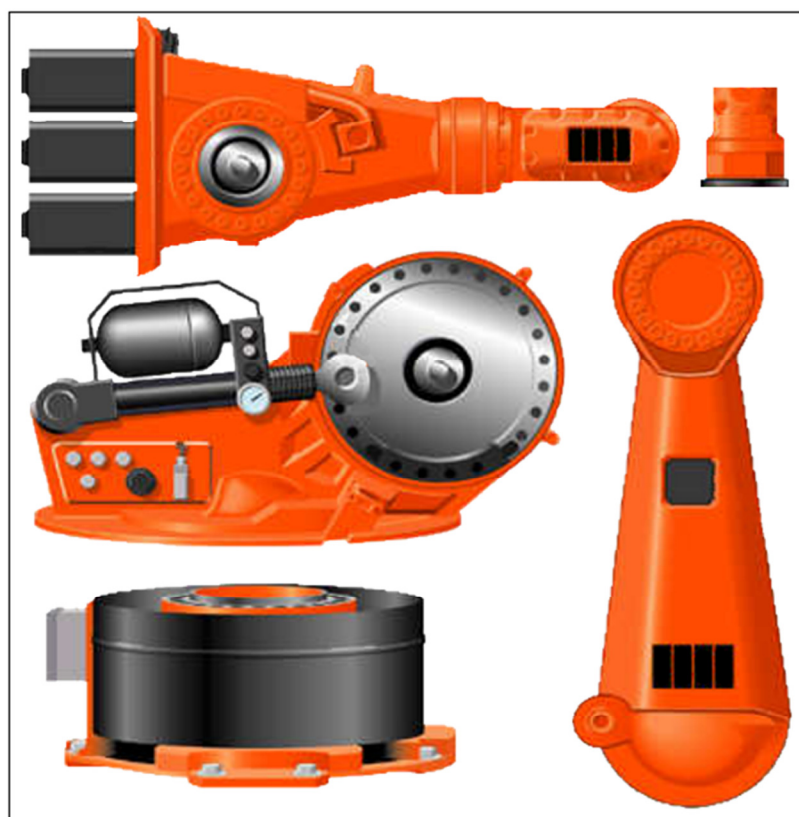
Figura 28 Vista explodida que mostra as principais peças do robô para esta aplicação.
